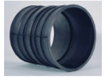
MANCHON DE SCELLEMENT pour chambre de visite béton ou maçonnée. Profondeur 11 et 24 cm. Ø 160 à 630 mm
